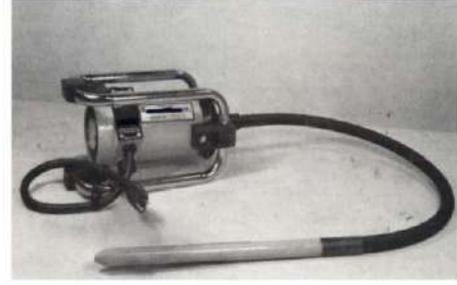
شكل (٧-٤) مزمار خرسانة يحرك زمة يعمل بالكهرباء.
