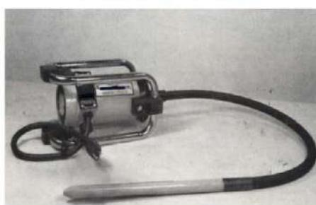
شكل (٤-٧) هواز خرسانة يحرك زبة يعمل بالكهرباء.
