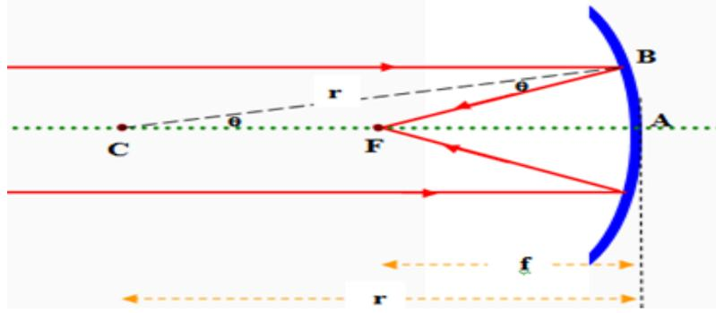
لنأخذ شعاع ضوئي يسقط موازي للمحور الضوئي للمرآة عند النقطة B على سطح المرآة ينعكس ماراً بالبؤرة F. من الشكل السابق نجد أن المسافة CB تساوي  $r$  (نصف قطر التقعر) و عمودي على سطح المرآة عند النقطة B، من الشكل السابق نجد أن المثلث CBF متساوي الساقين أي أن المسافة CF تساوي المسافة FB، كما أن FB يساوي FA وحيث أن FA هي البعد البؤري فنستنتج من ذلك أن CA تساوي  $2f$  أي أن
